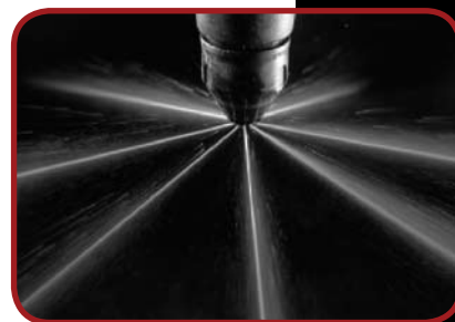
Dízel-befecskendező porlasztási képe: adalékotlan és adalékolt üzemanyaggal
