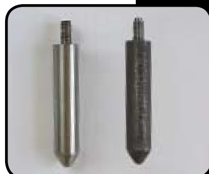
Korróziógátló adalék hatása MOL adalékkal ellátott és adalékotlan dízelgázolaj esetén
